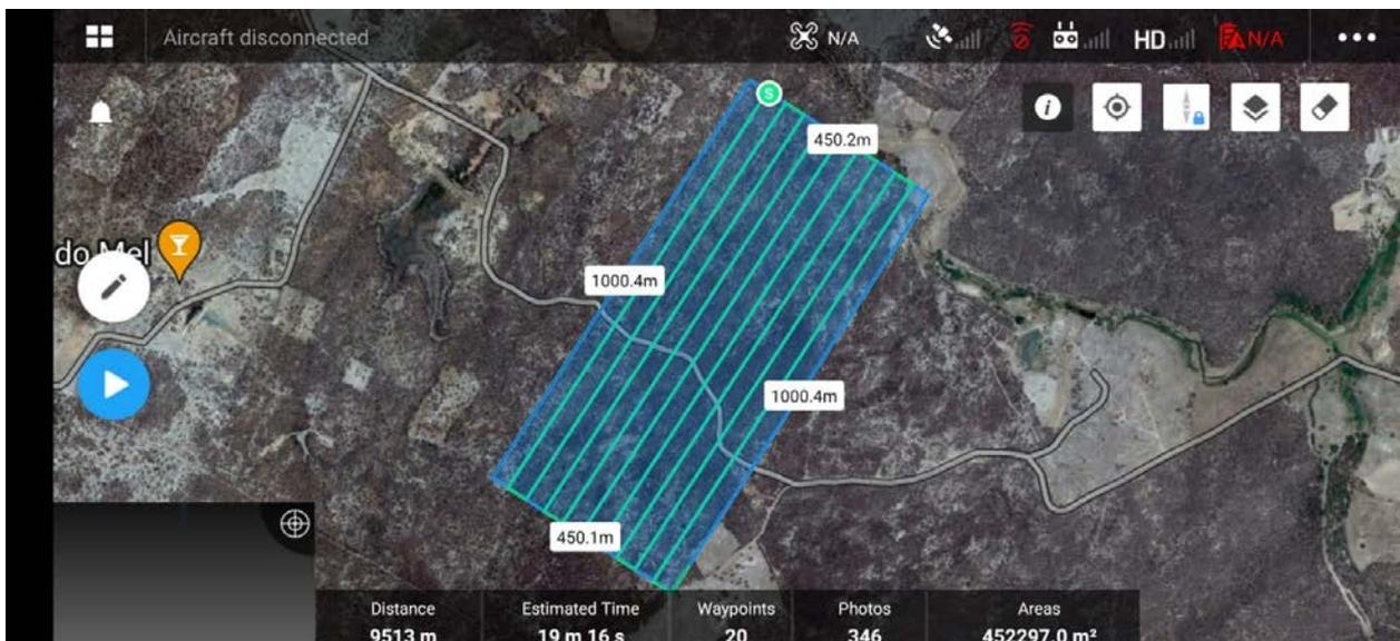
**Figura 2.4 – Interface do aplicativo Pilot e uma das missões planejadas pronto para execução**
